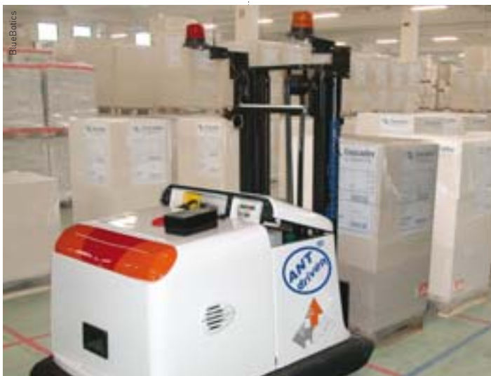
Novum «Paquito»: Mit der autonomen Navigationstechnologie ANT® BlueBotics ausgestattet, hat er eine Nutzlast von 1200 kg, handhabt bis zu 2,2 m hohe Paletten und wird sein Ziel im Gebäudeinnern sicher mit 1,3 m/sec. ansteuern.
