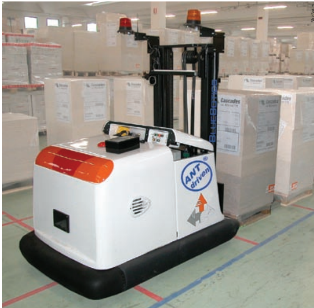
Paquito: Mit Bluebotics autonomer Navigationstechnologie ANT ausgerüstet, hat er eine Nutzlast von 1200 kg, handhabt bis zu 2,2 m hohe Paletten und wird sein Ziel im Gebäudeinnern sicher mit 1,3 m/s ansteuern.
